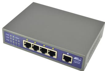
ATC-505P是非网管PoE交换机产品，提供5个10/100M自适应端口，每个端口均支持MDI/MDIX自动翻转功能，并可实现线速转发。4端口具有POE交换机功能，支持IEEE802.3af/at标准，可作为以太网供电设备，双模能自动检测识别符合IEEE 802.3af/at标准的受电设备，并通过网线为其供电。
